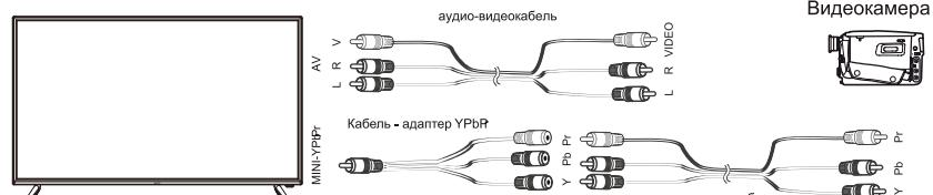
Подключите видеокамеру к телевизору, используя кабель-адаптер YPbPr или кабель-адаптер AV (кабели-адAPTERы в комплект поставки не входят).
