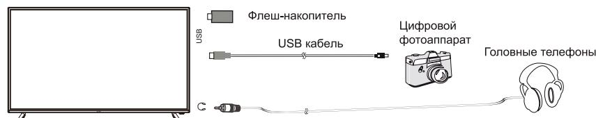
Разъем для подключения USB-устройства телевизора становится активным только в режиме Медиа.
