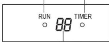
Установка температуры, времени, индикатор кода неисправностей.
